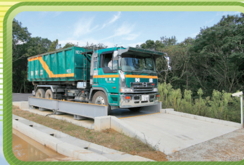
トラックスケール
