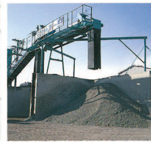
選別されて出てきた製品(路盤材)
